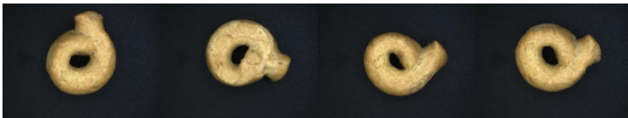
Obr.: příklad vstupních obrazových dat pro fázi učení i verifikace modelů ve formě snímků třídy OK s výrobky biskvit na dopravníkovém pásu.
